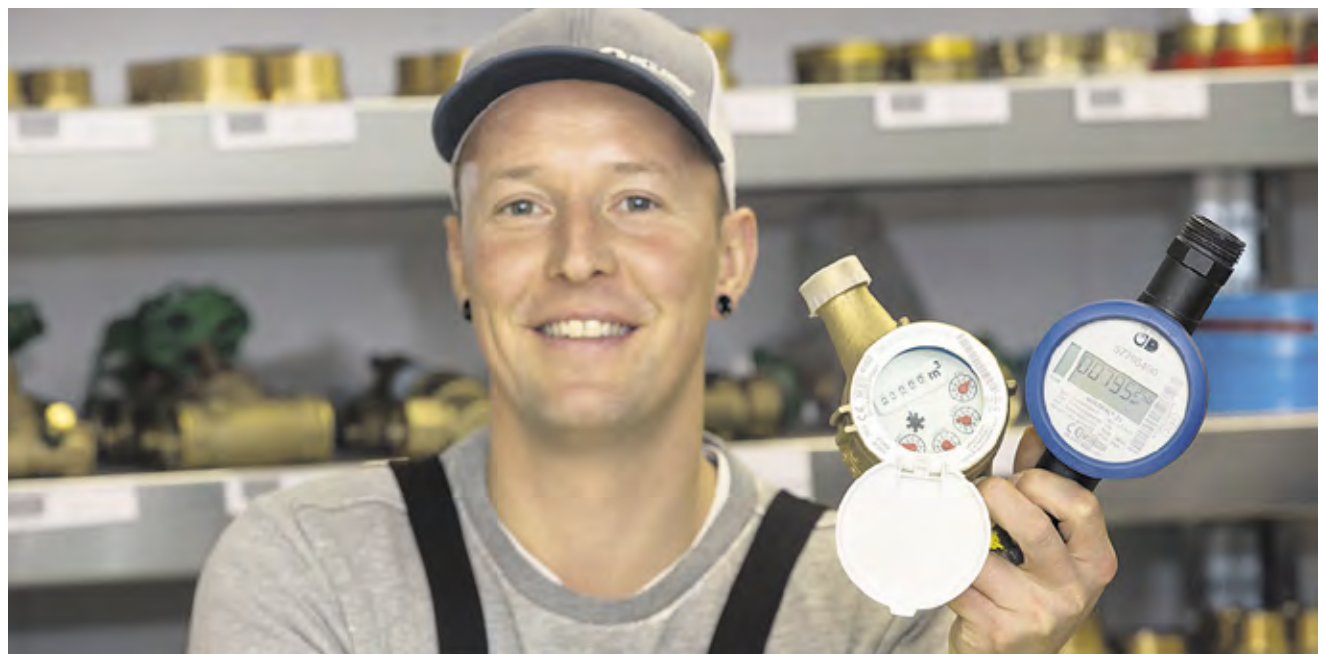
WAZV-Mitarbeiter Ricardo Wolf demonstriert den technischen Wechsel am Modell – vom analogen hin zum digitalen Wasserzähler. Foto: SPREE-PR/Gückel
